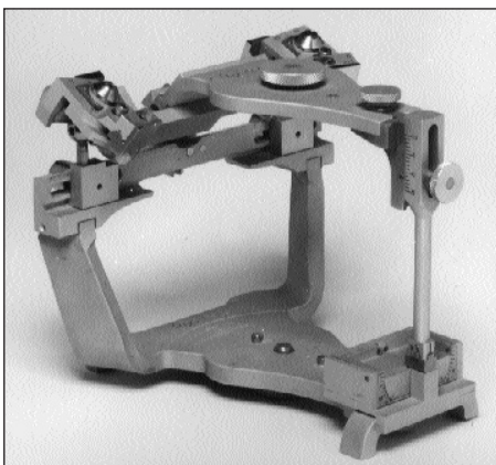
Denar articulator met instelbare Condylus- en Bennett-hoeken, alsook instelbare incisiefbaan en intercondylaire afstand voor een natuurgetrouwe nabootsing van onderkaakbewegingen.
