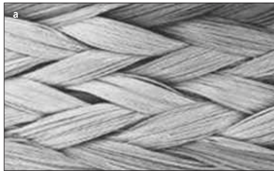
Afb. 2. Gevlochten (a) en geweven (b) vezels (Freilich et al, 2000).
