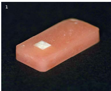
Afb. 1. Proefblokje voor de chemische methoden om het calcium- en fosfaatverlies te meten.
