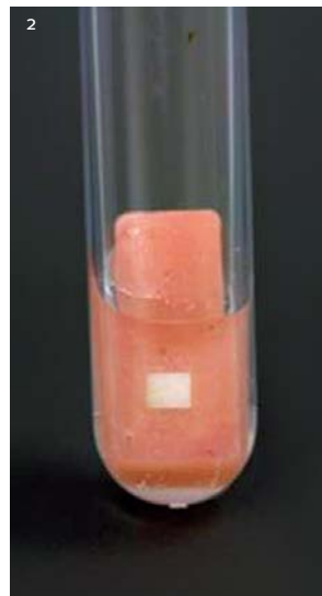
Afb. 1. Proefblokje voor de chemische methoden om het calcium- en fosfaatverlies te meten.
