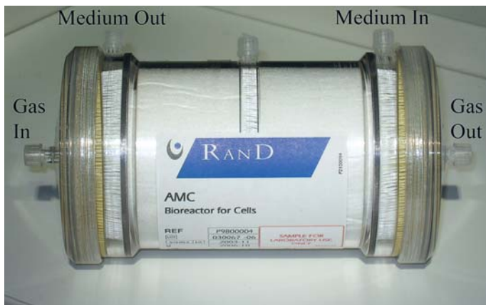
Afb. 2. Zij-aanzicht van de AMC-BAL met in- en uitgang voor medium (cq. plasma) en gas.
