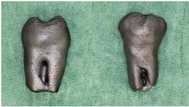
Afb. 6. Driedimensionaal geprinte kobalt-chroom replica's van een premolaar en derde molaar.
