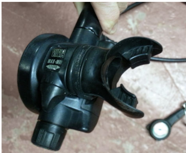
Afb. 5. Een voorbeeld van een standaard mondstuk van een duikuitrusting.
