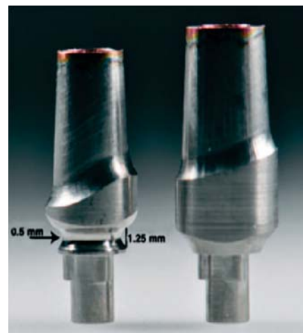
Afb. 1. Links het experimentele abutment (met een additionele uitholling van 0,5 mm diepte) en rechts het controle-abutment (met conventioneel divergerende vorm).
