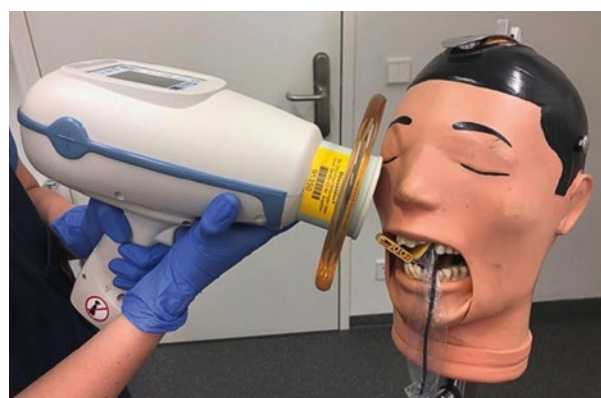
Afb. 1. Nomad Pro 2 met proefopstelling.
