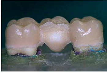
Afb. 3. Een brug is gechipt tijdens de vermoeiingstest (voor de breuktest).
