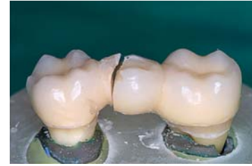
Afb. 5. Een brug die niet is gechipt tijdens de vermoeiingstest (na de breuktest).
