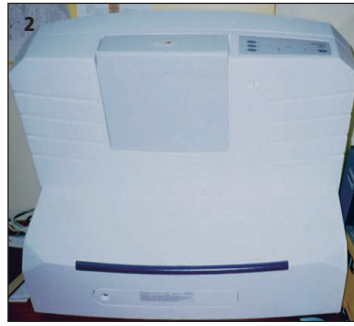
Afb. 2. Een speciale scanner voor het uitlezen van door röntgenstralen geactiveerde fosforplaten.
